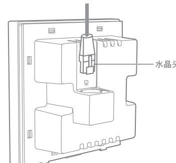
3 对准设备与暗盒上的螺丝孔，装入螺钉以固定，请勿将螺钉拧得过紧。
